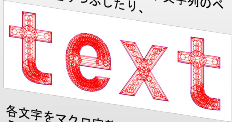
各文字をマクロ定義のアウトラインプリミティブとして出力したりします。
